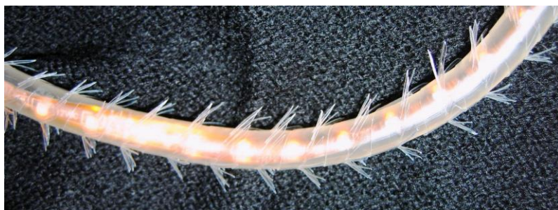
Рис. 2. Щетинки на осветителе с функцией носителя биомассы
