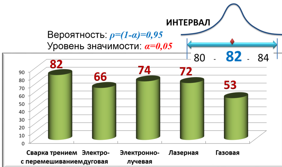
Рис. 5. Диаграмма сравнения технологических вариантов по интегральной оценке
