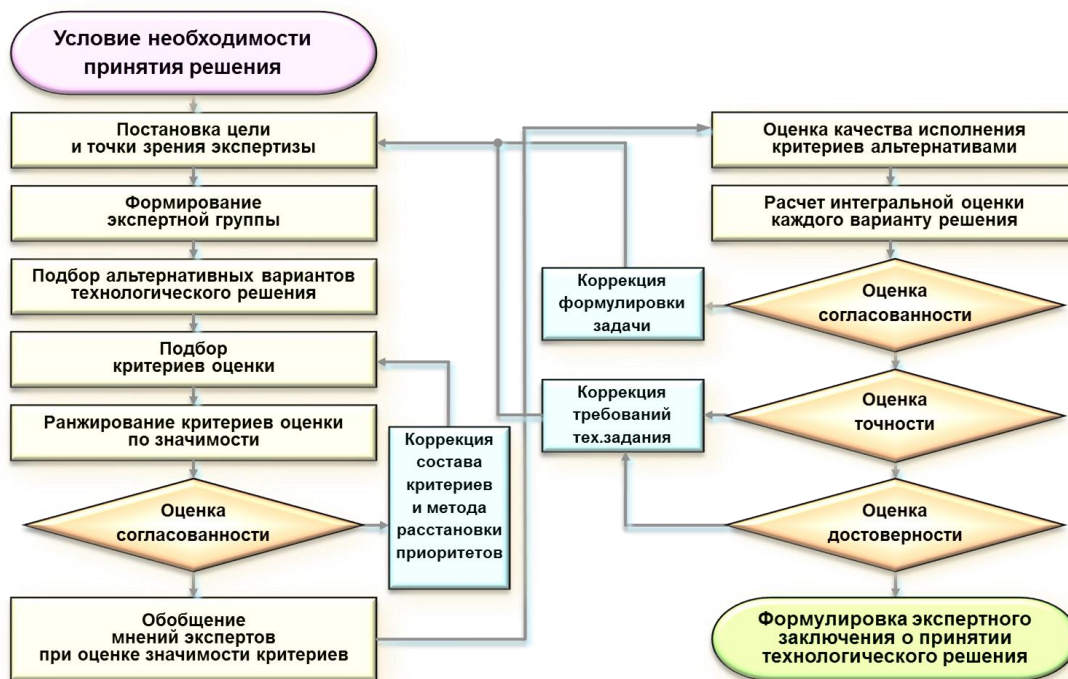
Рис. 2. Блок-схема алгоритма экспертной оценки при коллективной экспертизе
