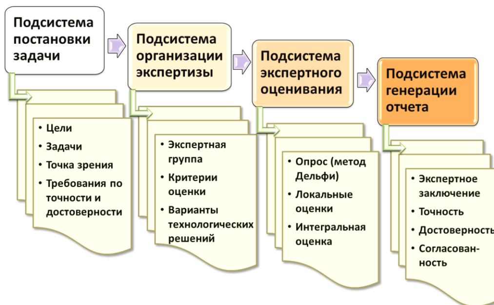
Рис. 1. Структура автоматизированной системы технологической экспертизы
