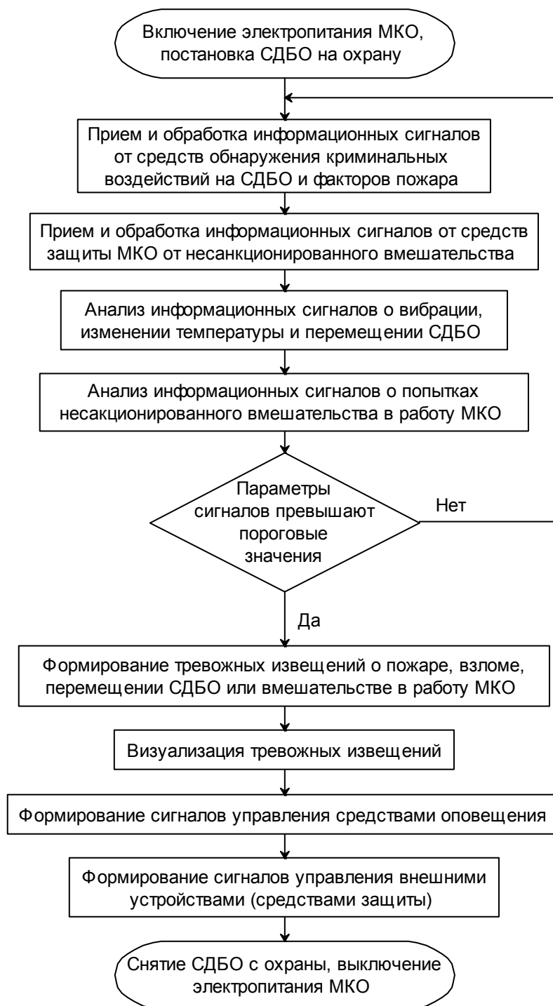
Рис. 2. Блок схема алгоритма функционирования МКО СДБО
