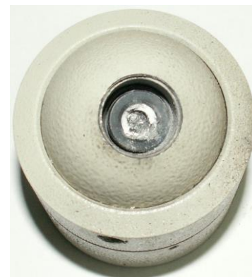
Результат попадания в вандалозащищённую видеокамеру пули из пистолета МР-79-9ТМ
