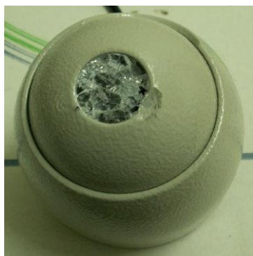
Результат попадания в вандалозащищённую видеокамеру стальным шариком из рогатки
