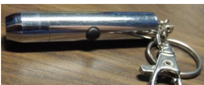
Лазерная указка мощностью 10 мВт, длина волны 650 нм (цвет излучения – красный)
