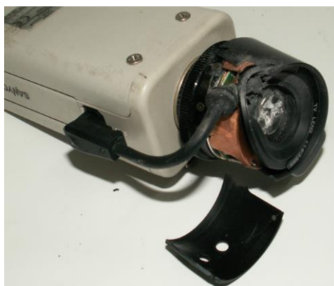
Результат попадания во внутреннюю видеокамеру пули из пистолета МР-79-9ТМ
