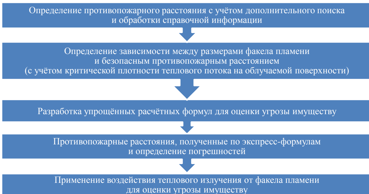
Рис. 1. Блок-схема редукции нормативной информации при оценке воздействия теплового потока на соседнее здание (сооружение)
