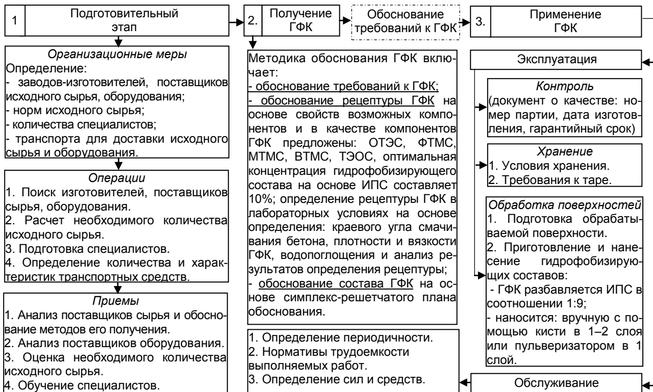
Рис. 5. Этапы подготовки, получения и применения гидрофобизирующих композиций на спиртовой основе
