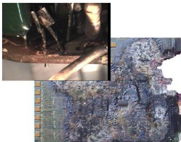
Рис. 3. Примеры возгорания плат в результате коротких замыканий, сформированных токопроводящими перемычками дендритами
