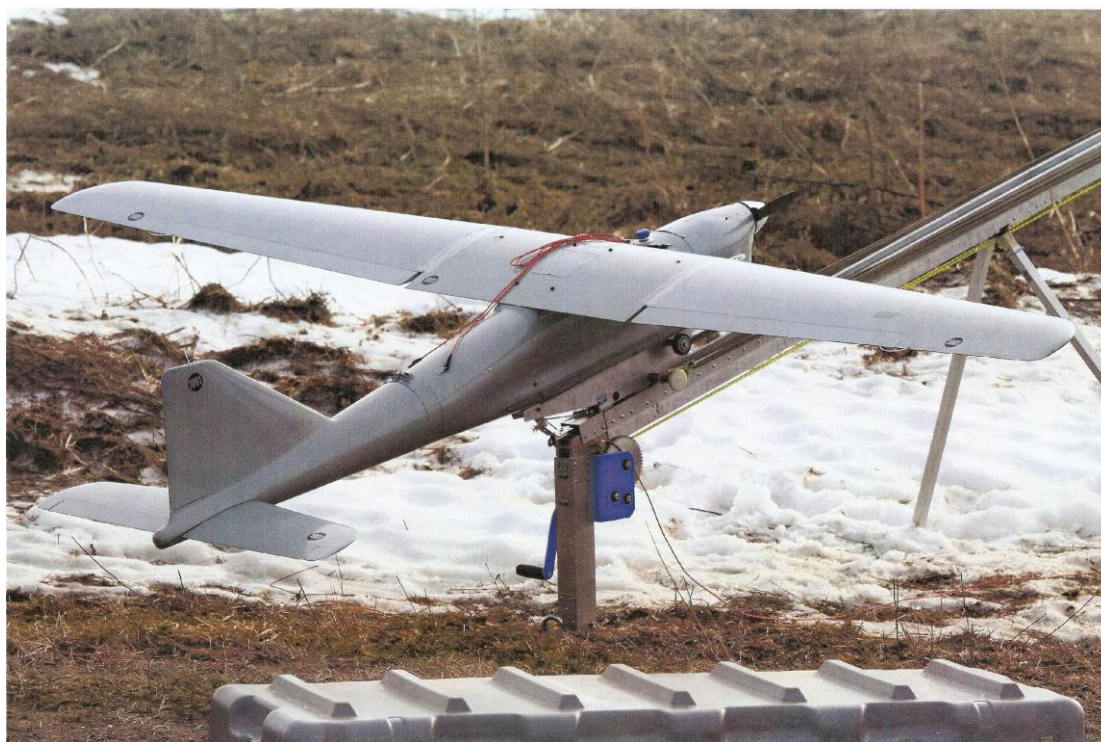
Рис. 2. БЛА "Орлан-10" на пусковом устройстве (катапульте)
