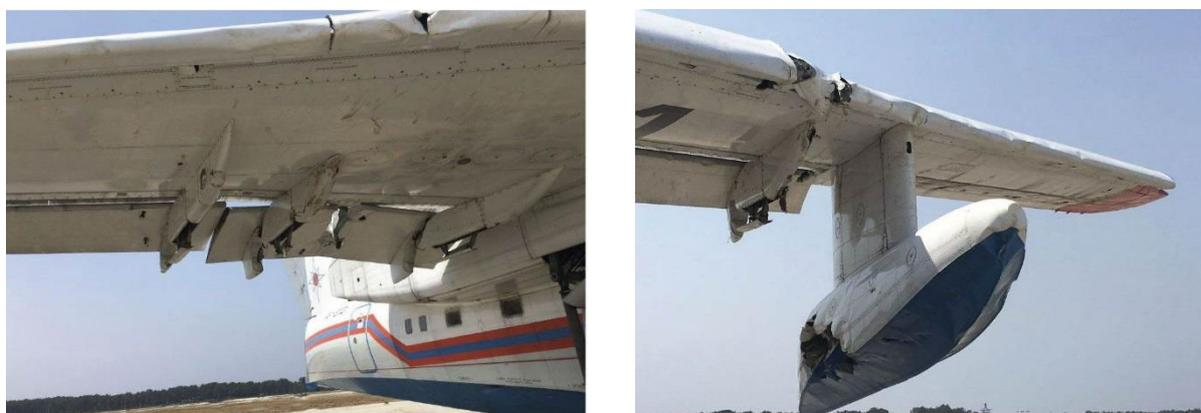
**Рис. 1.** Поврежденные крылья самолета Бе-200
