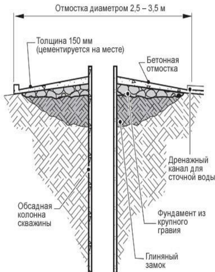
Рис. 7. Санитарное уплотнение и отмостка скважины
