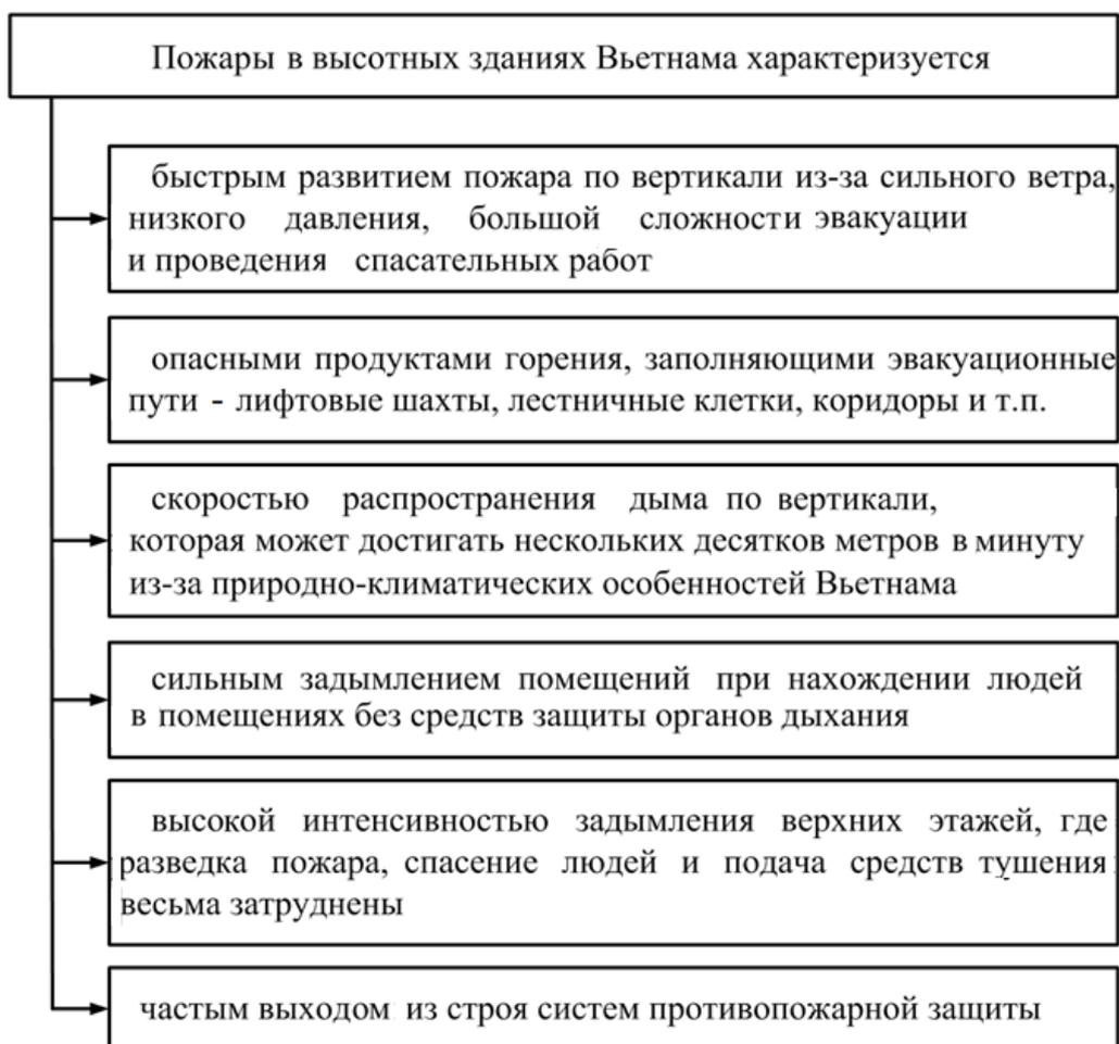
**Рис. 4.** События, которые характерны для пожаров в высотных зданиях Вьетнама
