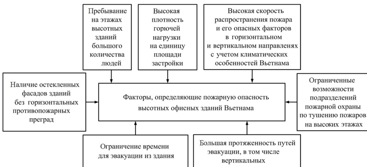
**Рис. 3.** Факторы, определяющие пожарную опасность высотных офисных зданий Вьетнама
