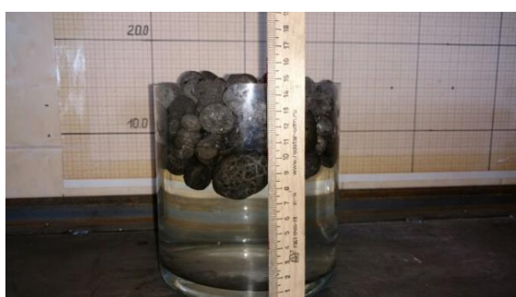
Рис. 2. Подложка ( h = 7 см, \Phi -20-30 мм) в воде
