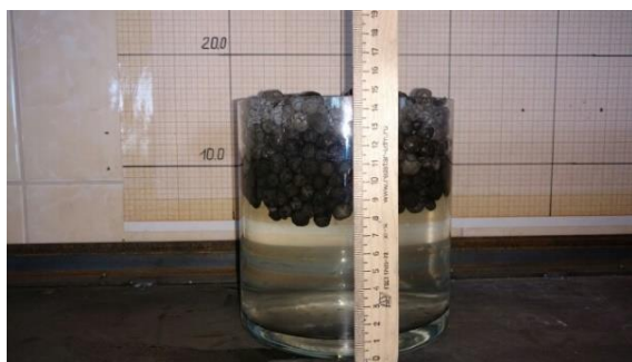
Рис. 4. Подложка ( h = 7 см, \Phi -10-20 мм) в воде
