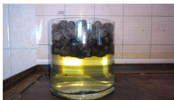
Рис. 3. Подложка ( h = 7 см, \Phi -20-30 мм) в бензине АИ-92
