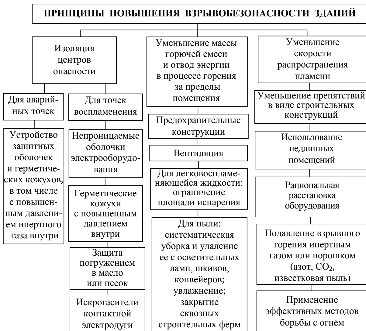
Рис. 2. Принципы повышения взрывобезопасности зданий
