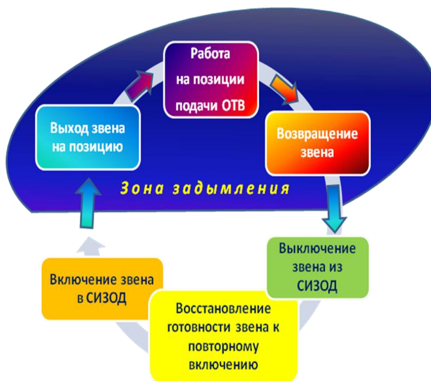
Рис. 5. Этапы действий звена ГДЗС при работе в условиях задымления
