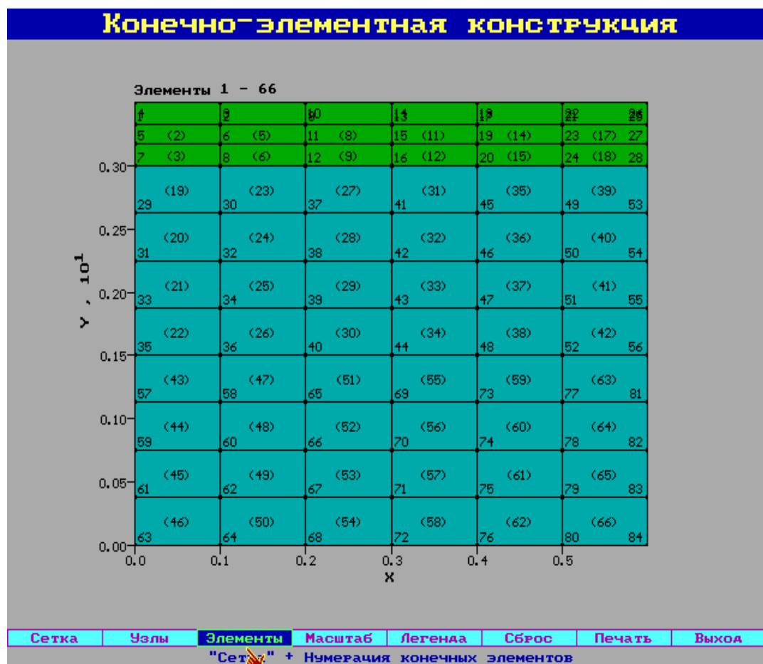
Рис. 4. Конечно-элементная конструкция в программе "КОКОН"
