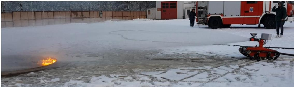
**Рис. 6.** Тушение модельного очага мобильной роботизированной установкой пожаротушения
