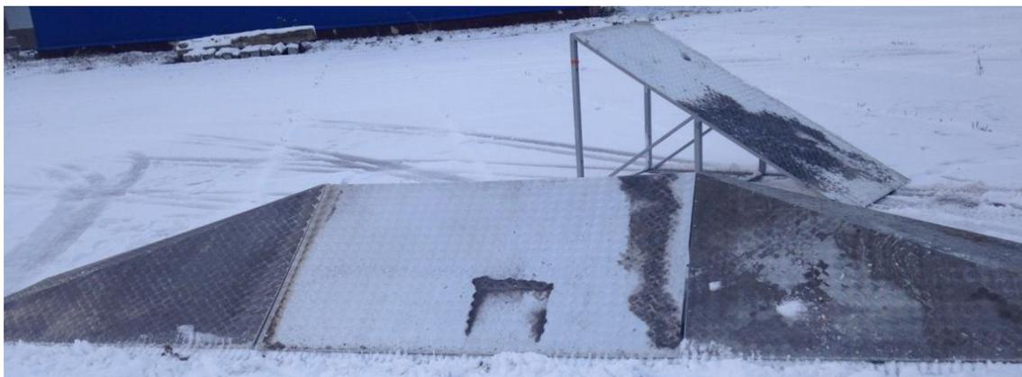
**Рис. 5.** Стенды для оценки ходовых характеристик мобильной роботизированной установки пожаротушения
