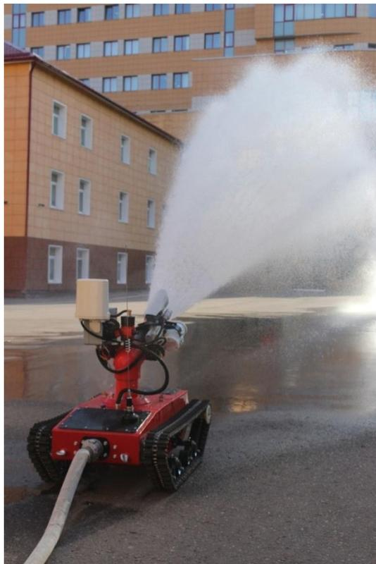
**Рис. 4.** Подача огнетушащих веществ с использованием мобильной роботизированной установки пожаротушения
