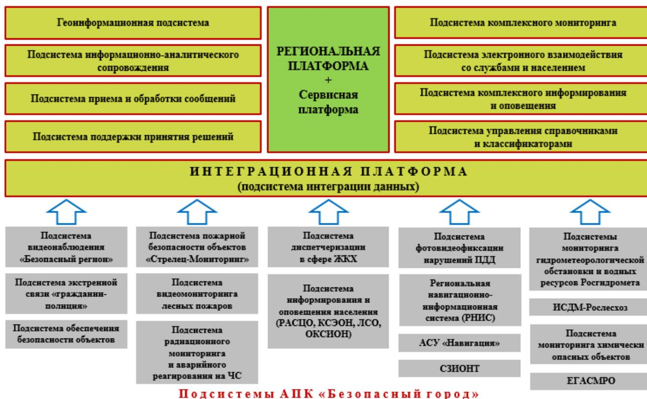
Рис. 2. Системная архитектура АПК "Безопасный город" Московской области
