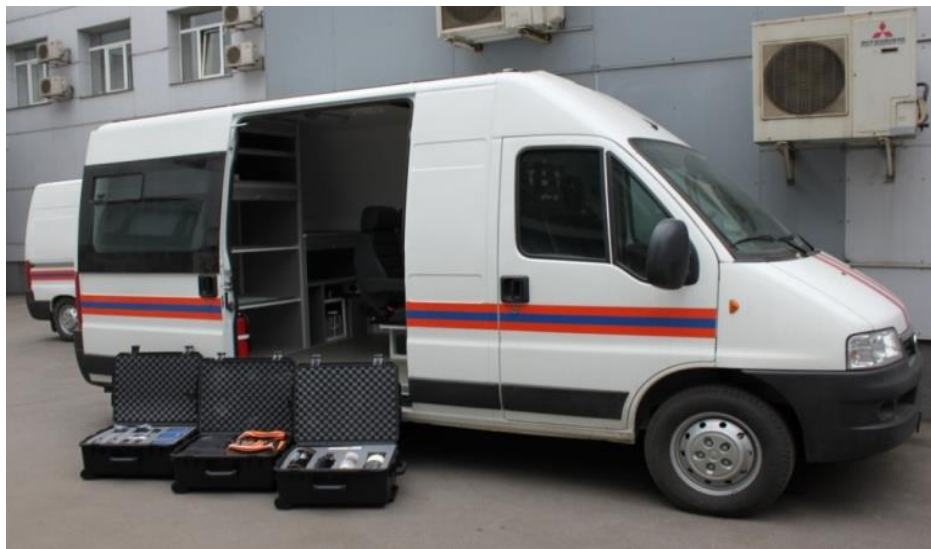
Рис. 4. Передвижная радиометрическая лаборатория (Транспортная платформа на базе автофургона и оборудование лаборатории в кейсах)
