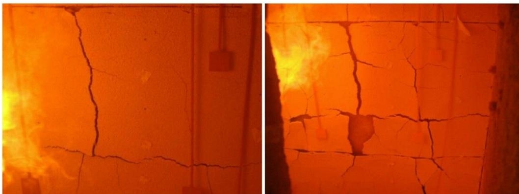
**Рис. 1.** Состояние поверхности гипсовых плит через 35 (слева) и 44 (справа) мин в условиях воздействия стандартного температурного режима пожара [10]
