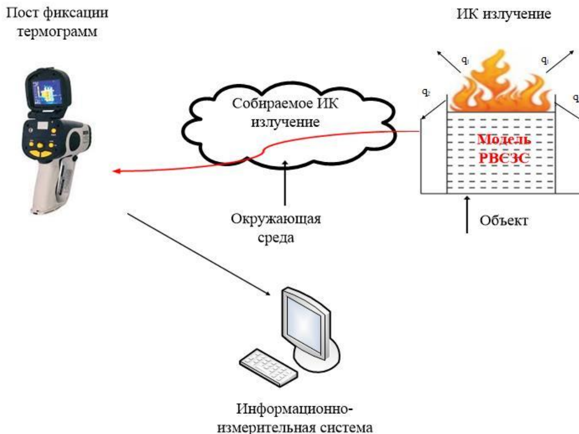
Рис. 4. Схема проведения измерения температуры на защитной стенке модельного резервуара типа "стакан в стакане": q_1 – излучение, направленное в окружающую среду; q_2 – излучение, действующее на защитную стенку при пожаре в основном резервуаре
