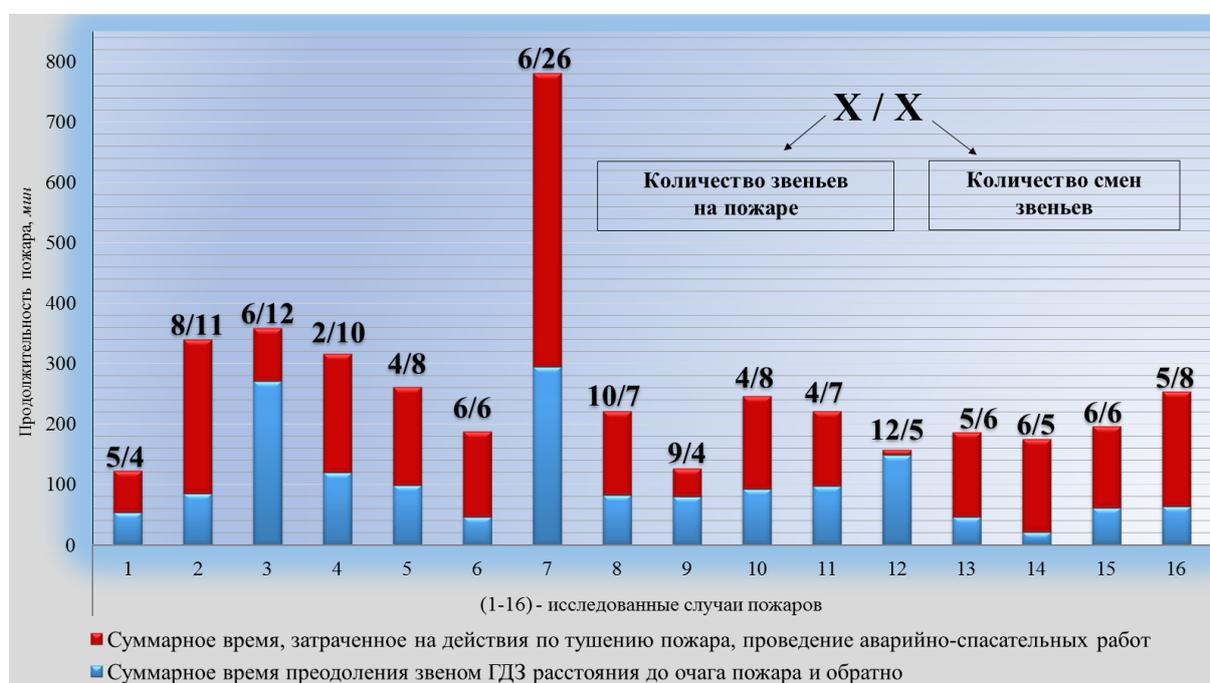
**Рис. 8.** Включение звена ГДЗС в СИЗОД при давлении в баллонах  $260 \text{ атм}$  на пожарах предприятий лесной, деревообрабатывающей и целлюлозно-бумажной промышленности
