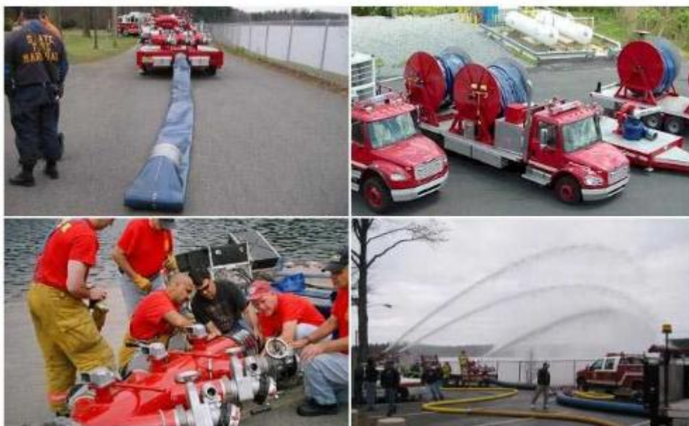
Рис. 2. Применение трубопровода из плоскосворачиваемых рукавов при тушении пожаров
