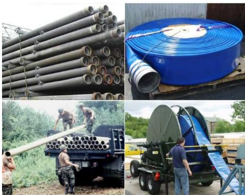
Рис. 1. Металлические трубы и плоскостворачиваемые рукава
