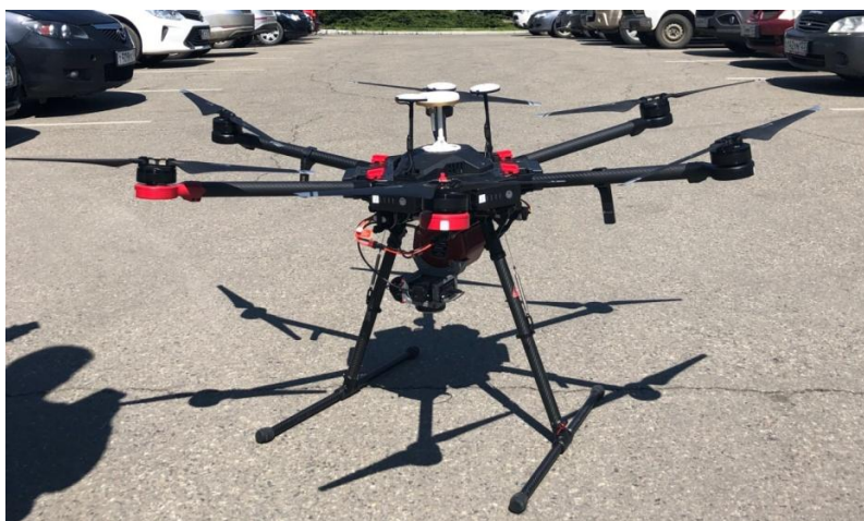
Рис. 1. Система мобильного лазерного сканирования АГМ-МС3.100, установленная на БПЛА (дрон) DJI Matrice M600
