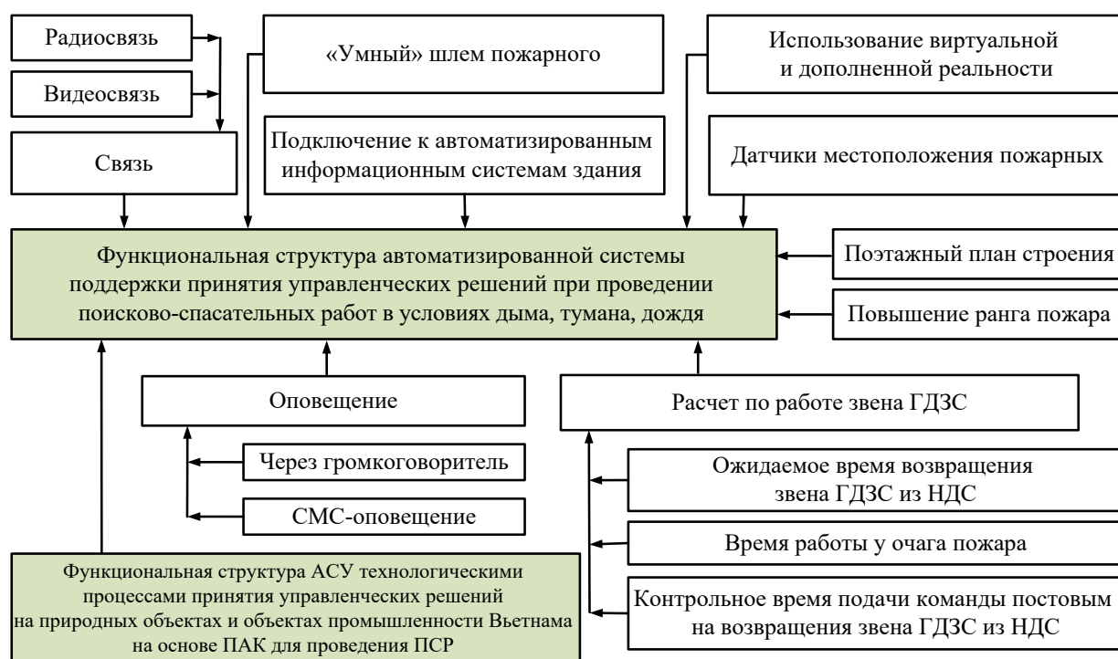
Рис. 6. Модель функциональной структуры автоматизированной системы поддержки принятия управленческих решений при проведении ПСР в условиях дыма, тумана, дождя
