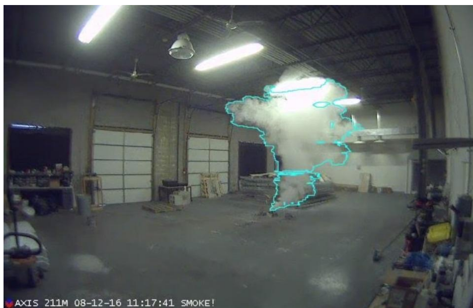
Рис. 4. Детекция дыма системой SigniFire 8
