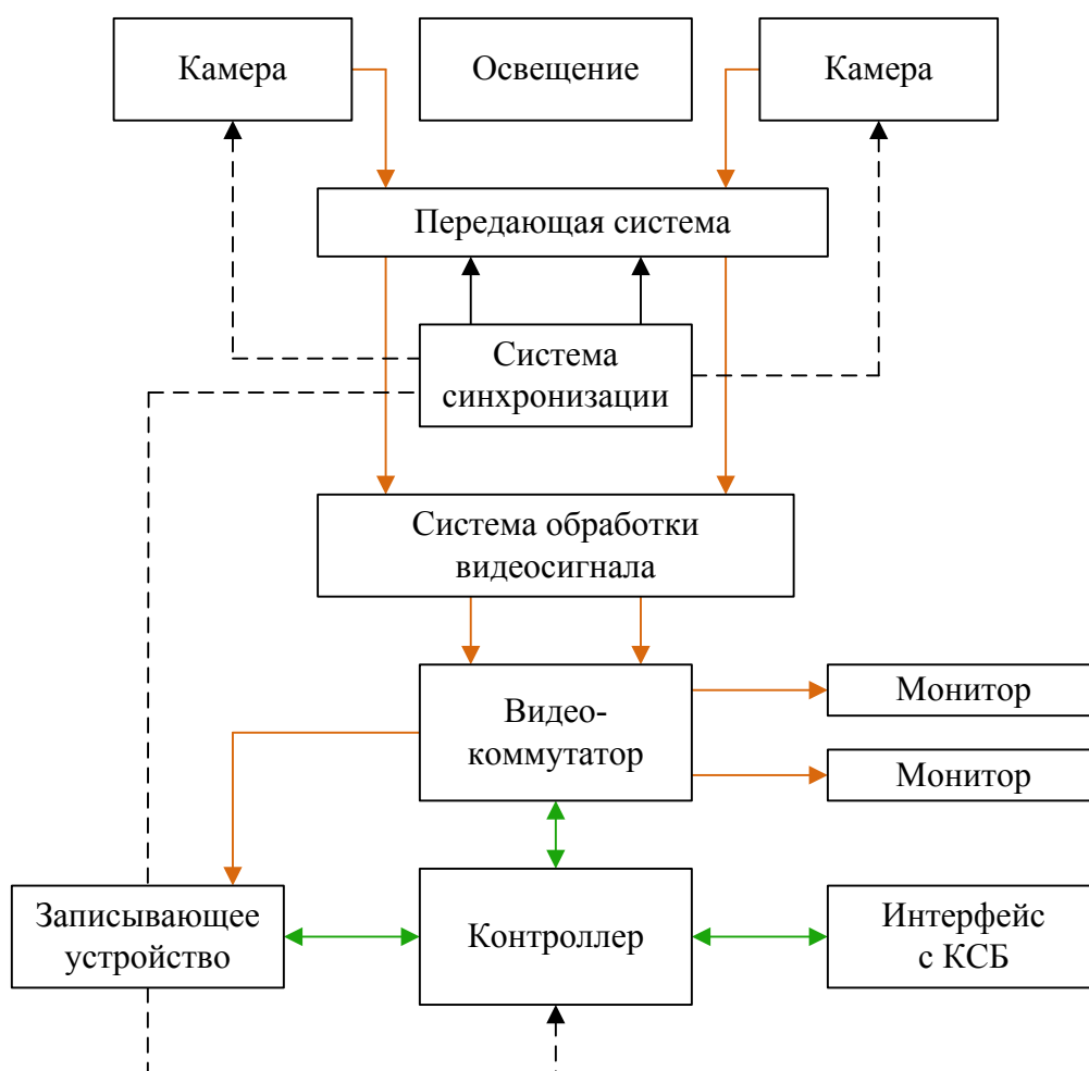
Рис. 1. Структура и состав системы видеонаблюдения
