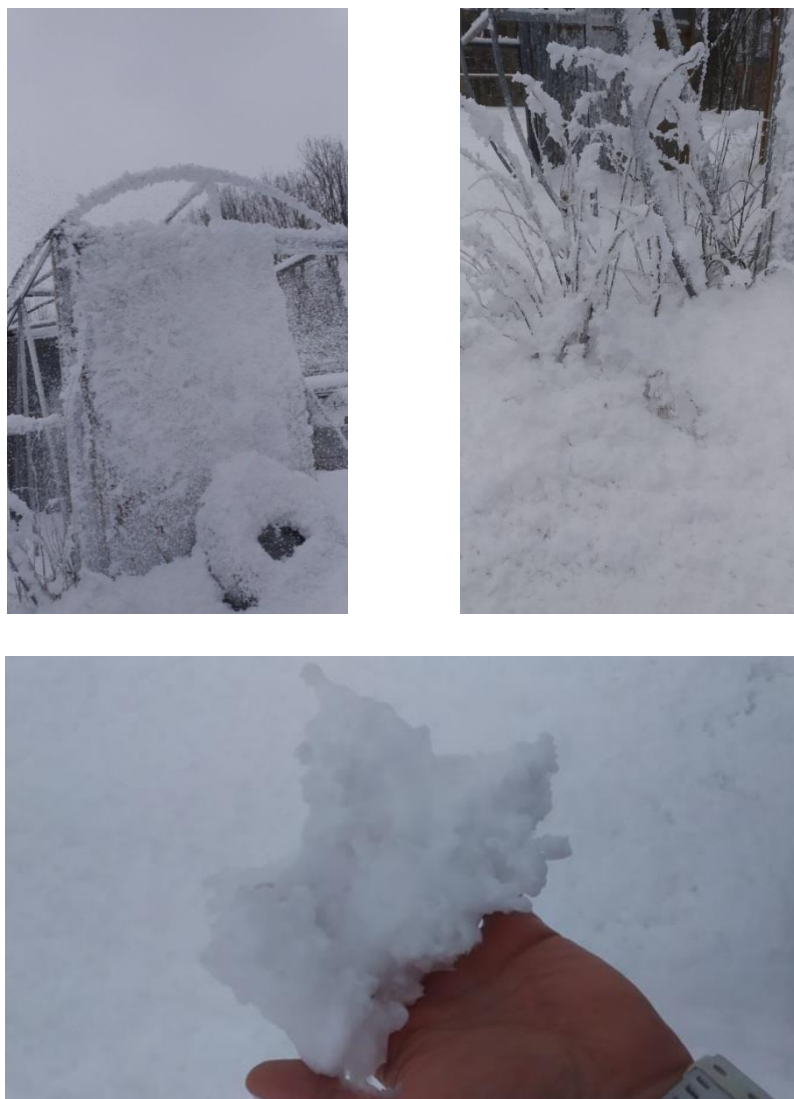
Рис. 6. Вид компрессионной пены после подачи по насосно-рукавным системам при температуре воздуха t = -15\text{ }^{\circ}\text{C}
