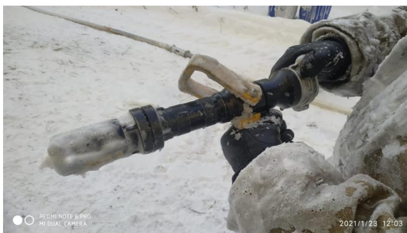
Рис. 7. Внешний вид перекрывного ствола после подачи по насосно-рукавным системам компрессионной пены при температуре воздуха t = -30\text{ }^{\circ}\text{C}
